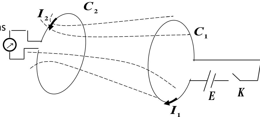
Au cours du temps  $dt$  que dure cette fermeture, le courant  $i_1$  passe de 0 à  $i_1$  maximum. Il en résulte, à travers  $C_2$ , une variation du flux  $d\Phi$  et l'apparition d'une force électromotrice induite
